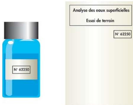
Figure 17 : Désignation des échantillons par étiquette avec un code
