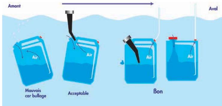
Figure 10 : Technique de prélèvement en bidon à double ouverture
