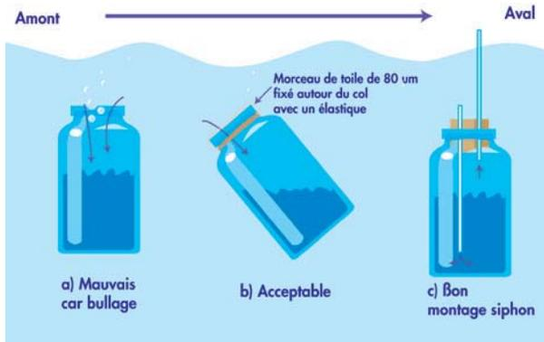
Figure 9 : Autres techniques de prélèvement en bouteille
