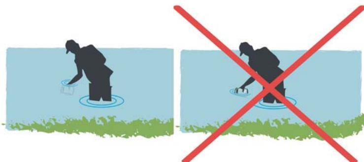
Figure 6 : Échantillonnage des eaux sous la surface
